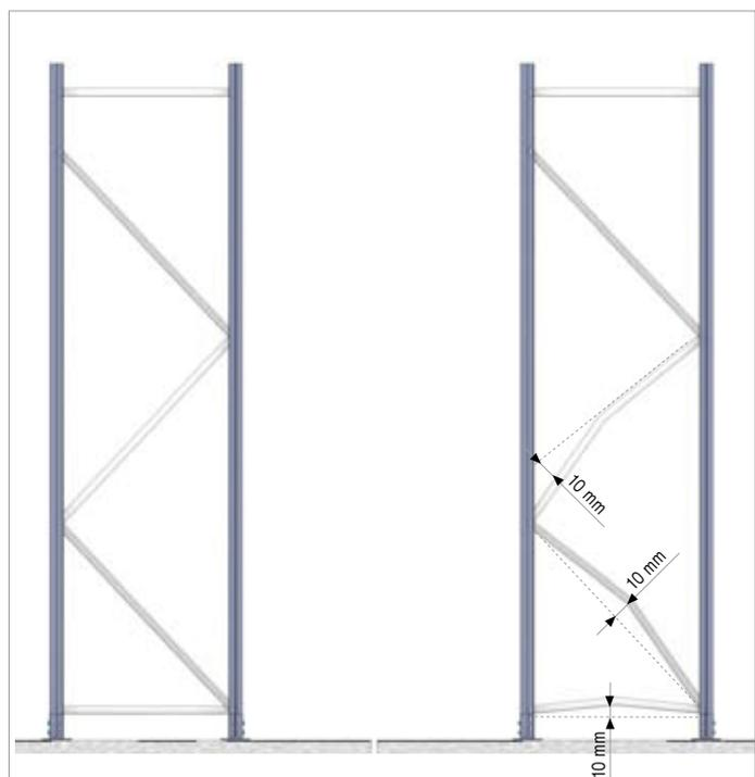
**A)** Montants pliés dans le sens du plan de l'échelle. Déformation permanente supérieure ou égale à 3 mm mesurée au centre d'un intervalle de 1 m de long.
