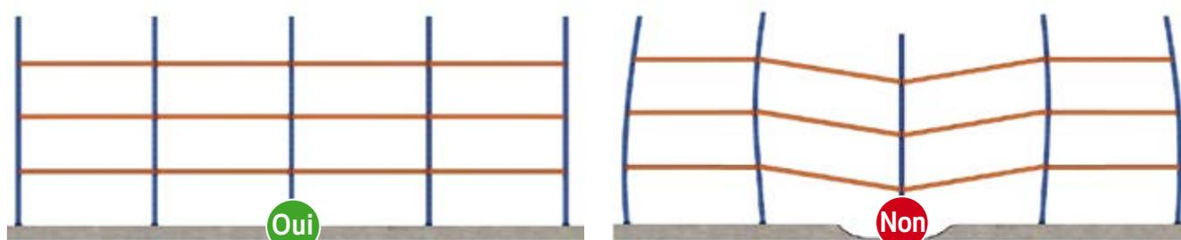
Les éventuelles irrégularités du sol peuvent être corrigées à l'aide de plaques de nivellement qui doivent être correctement mises en place sous les pieds. Un mauvais positionnement de ces plaques peut entraîner une augmentation de la pression exercée sur la dalle, voire provoquer le déséquilibre de l'échelle.
