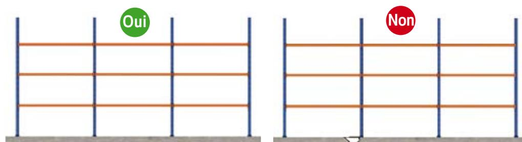
**Résistance :** le sol ne doit présenter aucune zone d'affaissement susceptible de provoquer l'écroulement de l'installation. Le sol doit posséder la résistance appropriée pour supporter les charges transmises sur les pieds par le système de stockage.
