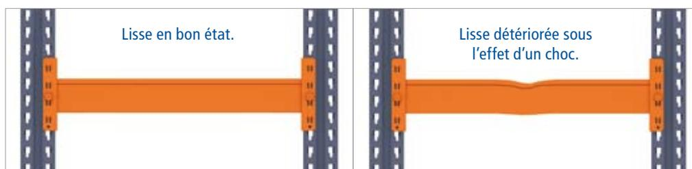
**Les détériorations localisées sous forme de bosselures, fêlures, etc. doivent systématiquement être évaluées. En cas de doute, le niveau doit être déchargé et la lisse endommagée remplacée.**
