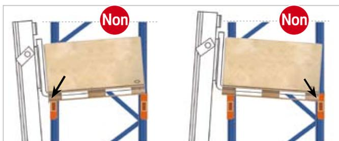
**Figure 10** Rotation de la lisse par traction ou poussée.
