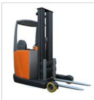
Chariot élévateur à mât rétractable.
