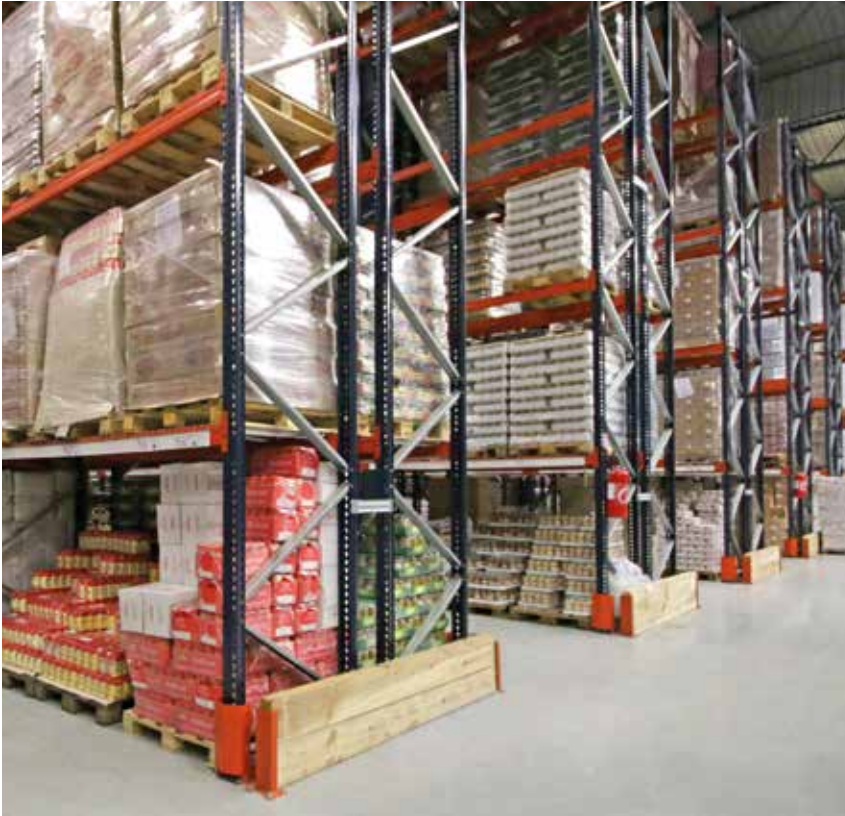
Protection latérale avec deux profils
