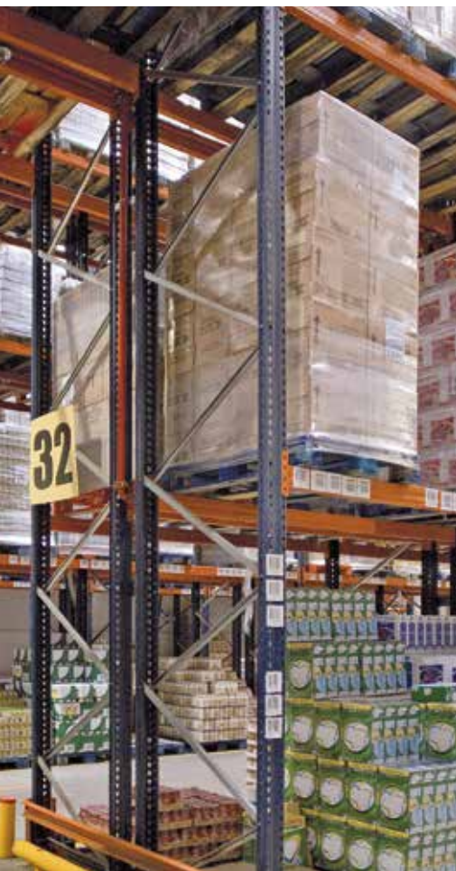
Entrepôt équipé de rayonnages à palettes manipulées par le côté de 800 mm
