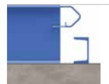
Détail du profilé utilisé pour les guides.
