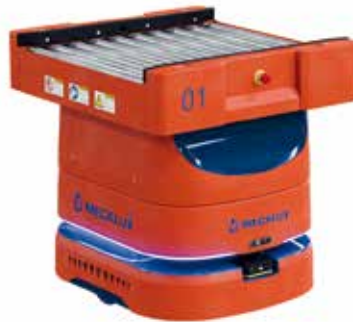
AMR 100 Box avec convoyeur à chargement latéral d'un bac de 600 mm de large.
