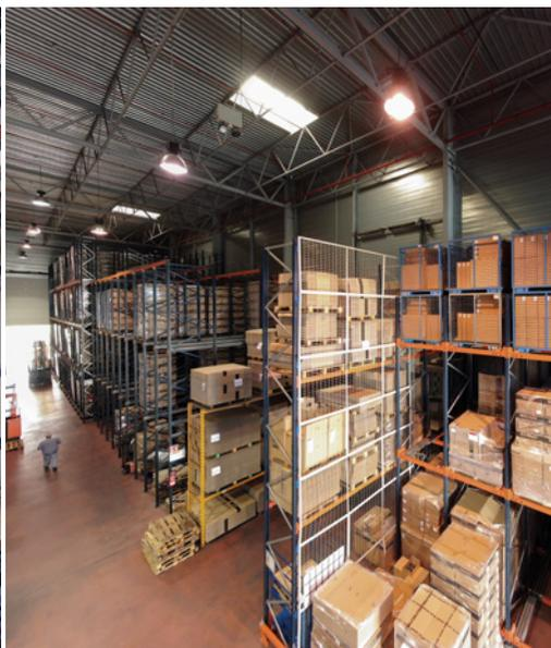
lettes en profondeur ; le second, formé par des rayonnages push-back avec une capacité de trois palettes en profondeur et un bloc de rayonnages dynamiques.
