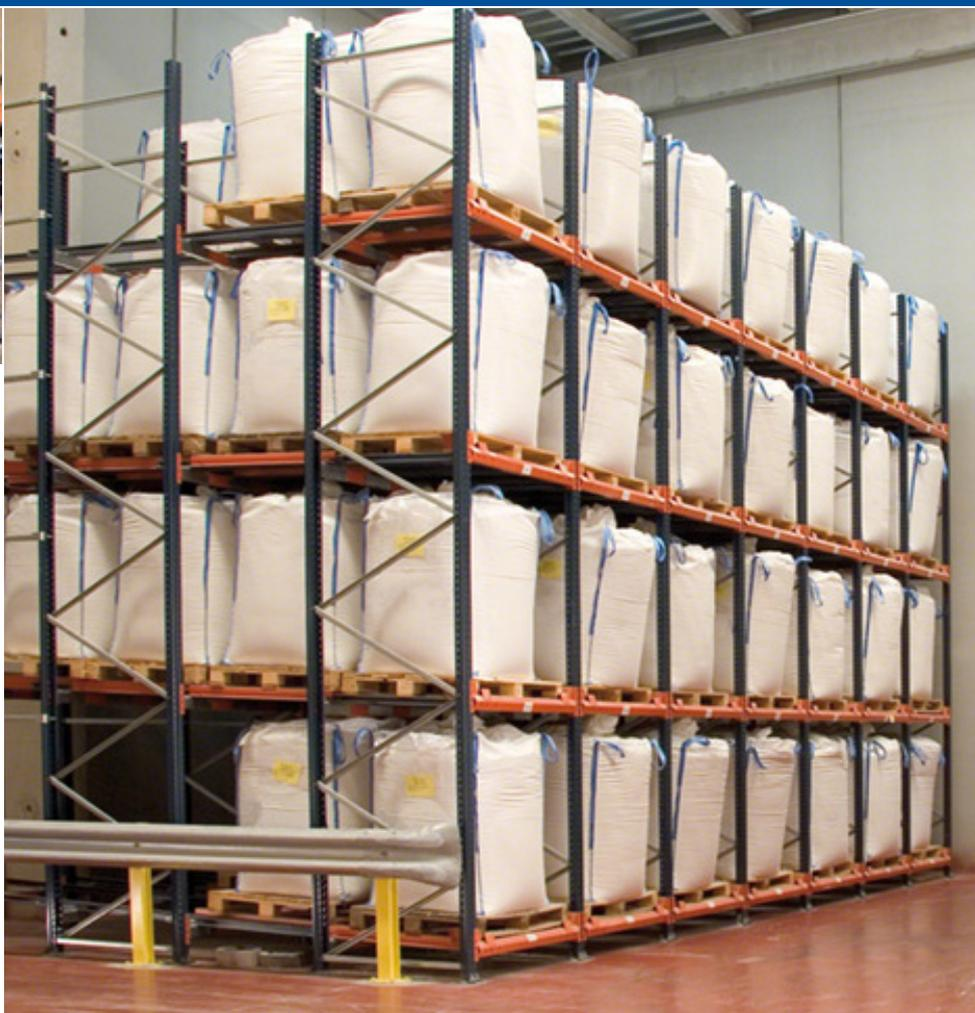
Dans les rayonnages push-back, le chariot élévateur manipule les palettes avec les patins inférieurs positionnés perpendiculairement, afin que ceux-ci s'appuient de manière transversale sur les chariots et les rails.
