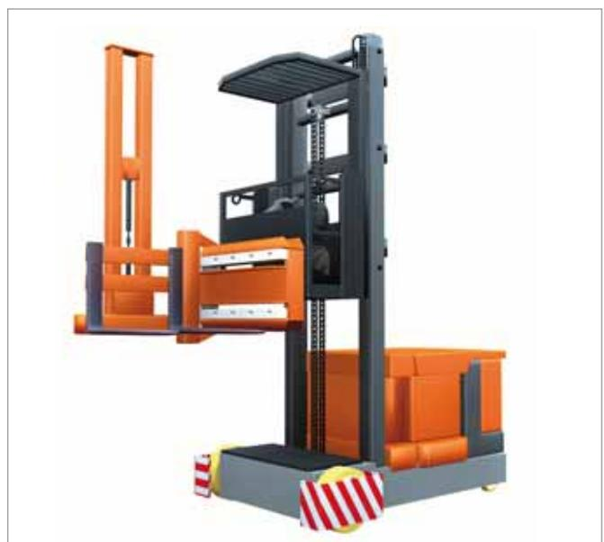
Les chariots préparateurs de commandes, de même que ceux à mât inclinable rétractable, doivent être guidés à l'intérieur des allées de stockage.
