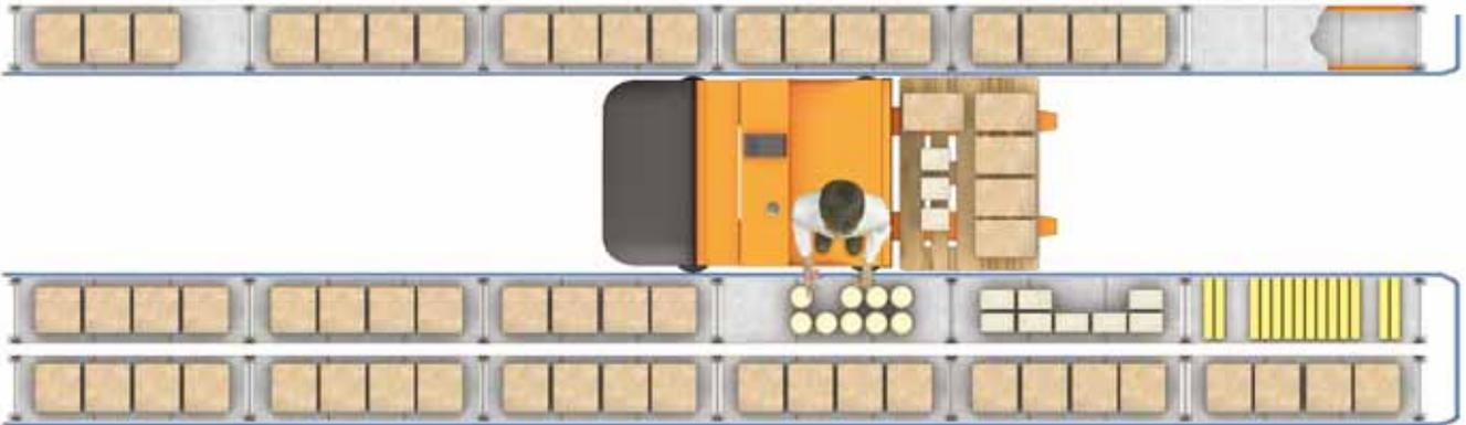
Chaque modèle de machine nécessite un type de rail-guide approprié et une largeur d'allée différente. La largeur de l'allée est définie par la distance entre les rails-guides et la distance entre les niveaux de charge.
