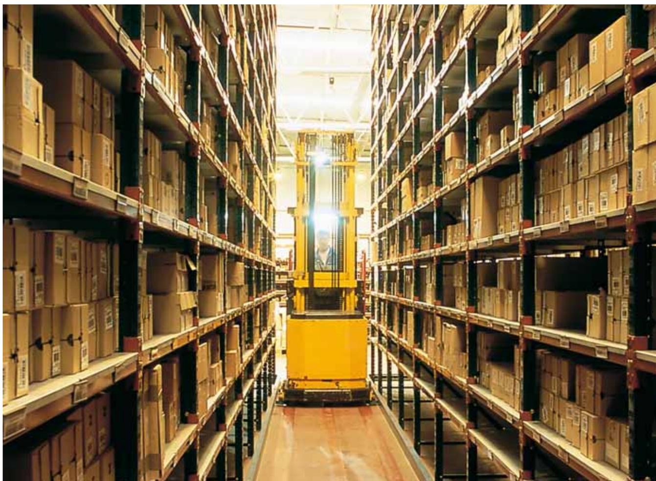
Il existe deux familles de machines, celles qui ne permettent de travailler que sur les niveaux les plus bas (préparateurs de commandes faible hauteur) et celles qui peuvent élever l'opérateur jusqu'aux niveaux les plus hauts des rayonnages (préparateurs de commandes en hauteur).
