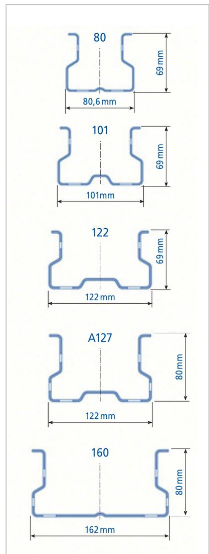
Les montants réalisés suite à ces calculs ont été développés avec des géométries spécifiques pour chaque type d'installation et couvrent tous les besoins de stockage en fonction de la hauteur, de la charge et de la distribution de l'installation (figure 8).
