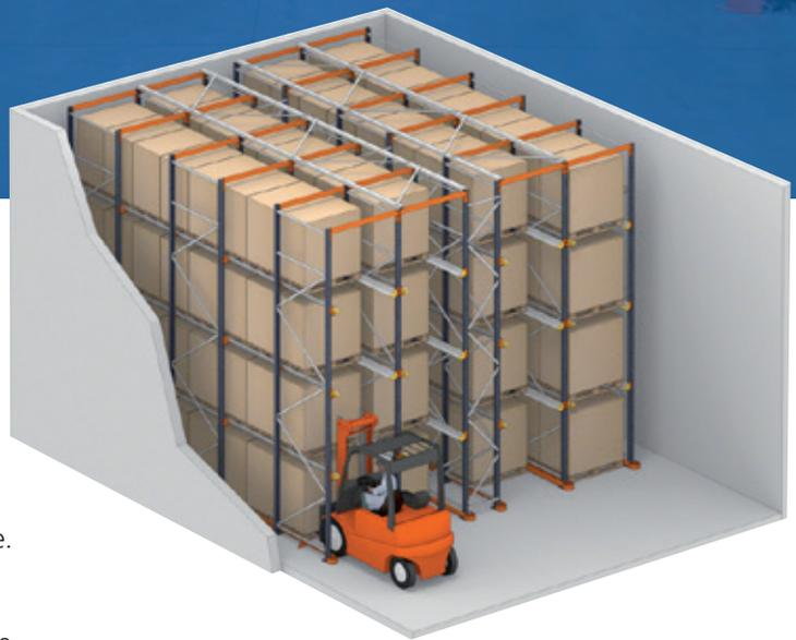
Les allées de stockage possèdent des rails de guidage de chaque côté, sur les différents niveaux où sont déposées les palettes. La grande résistance des matériaux composant ce type de rayonnages permet de stocker des palettes de charge lourde.
