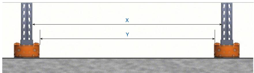
Un autre système de guidage localise les profils en U dans la partie inférieure des montants du rayonnage, et les maintient au sol grâce à ces mêmes ancrages.
