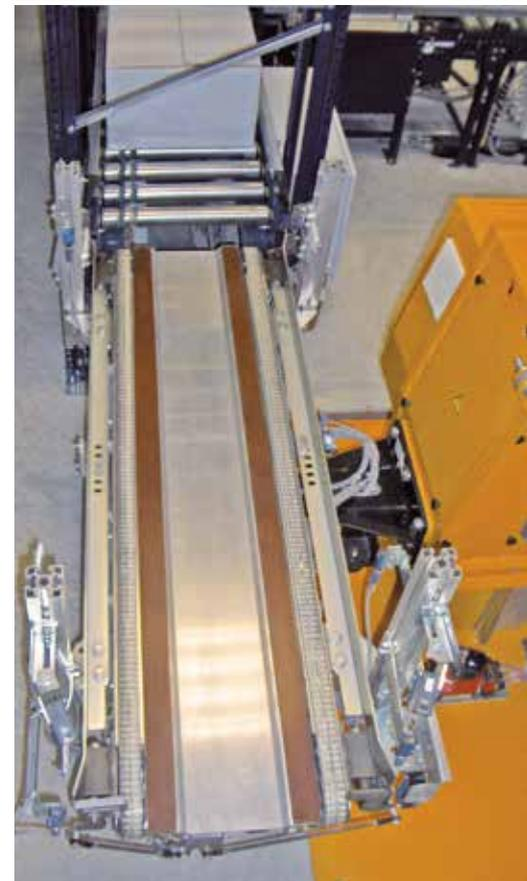
Détail de l'extracteur à pelles et à courroies.
