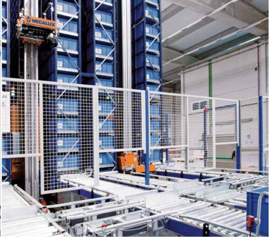
Les postes de picking peuvent aussi être installés dans les niveaux supérieurs. Cette solution conserve l'avantage des zones annexes et optimise l'utilisation de l'espace de la partie supérieure de l'entrepôt.
