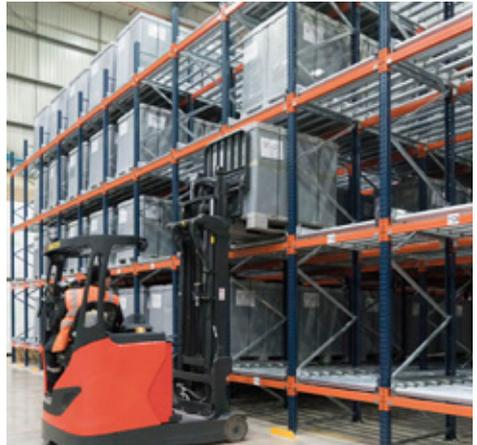
FLUX CONTINU : PAS D'INTERFÉRENCE ENTRE LES OPÉRATIONS DE CHARGEMENT ET DE DÉCHARGEMENT, CHAQUE OPÉRATION ÉTANT RÉALISÉE DANS UNE ALLÉE DIFFÉRENTE.
