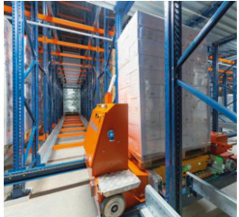
ASSOCIÉ À DES TRANSSTOCKEURS, LE SYSTÈME PALLET SHUTTLE PEUT ATTEINDRE UNE HAUTEUR DE STOCKAGE DE 40 MÈTRES.
