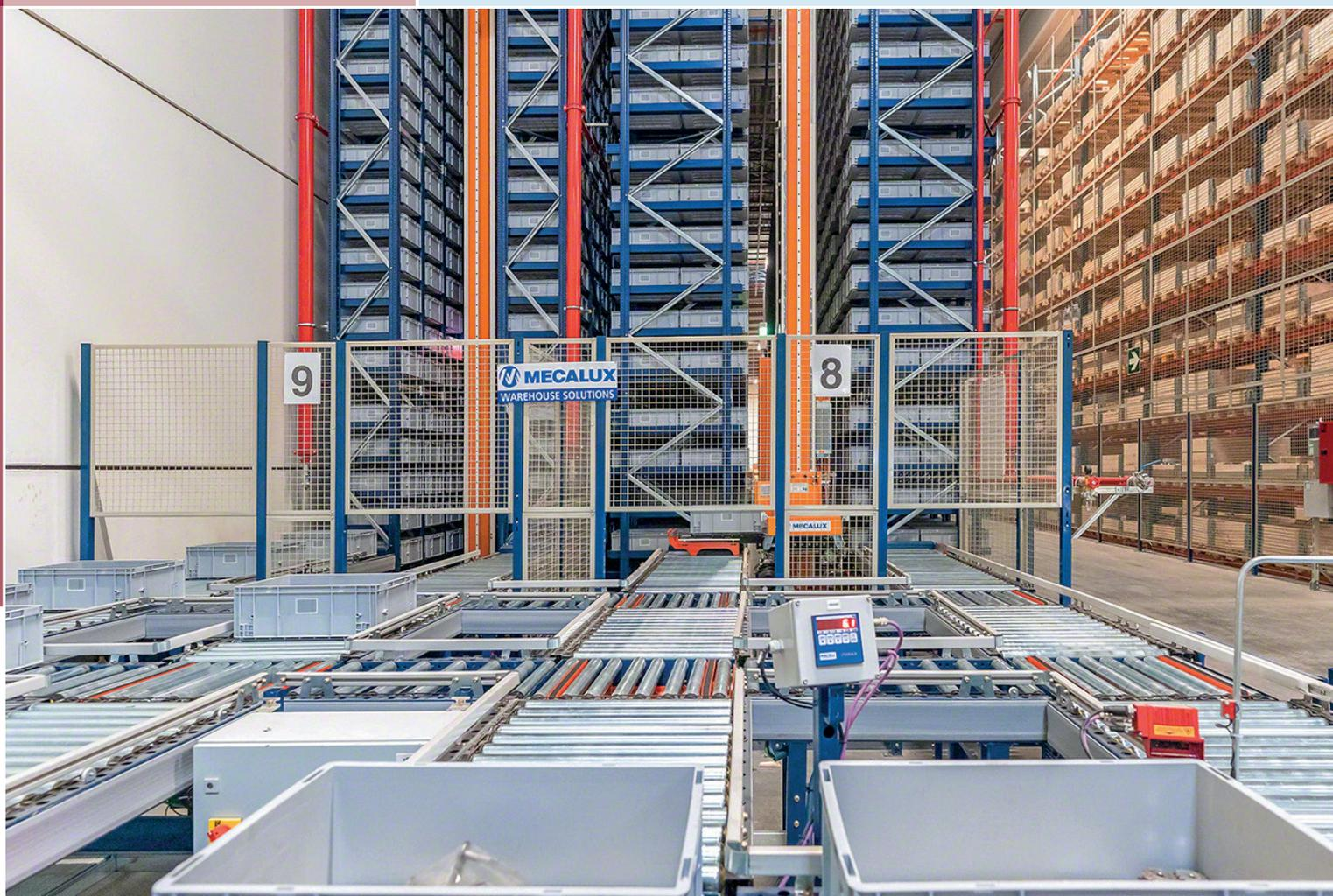
Les magasins automatiques Miniload (ou magasin automatique pour caisses) appliquent le principe du « produit vers l'homme » : les unités de charge (caisses), situées dans les rayonnages, sont manipulées automatiquement par un transstockeur, qui les rapproche de l'opérateur pour l'extraction ou le dépôt du produit. Par la suite, les caisses sont renvoyées à leur emplacement d'origine par le même procédé.
