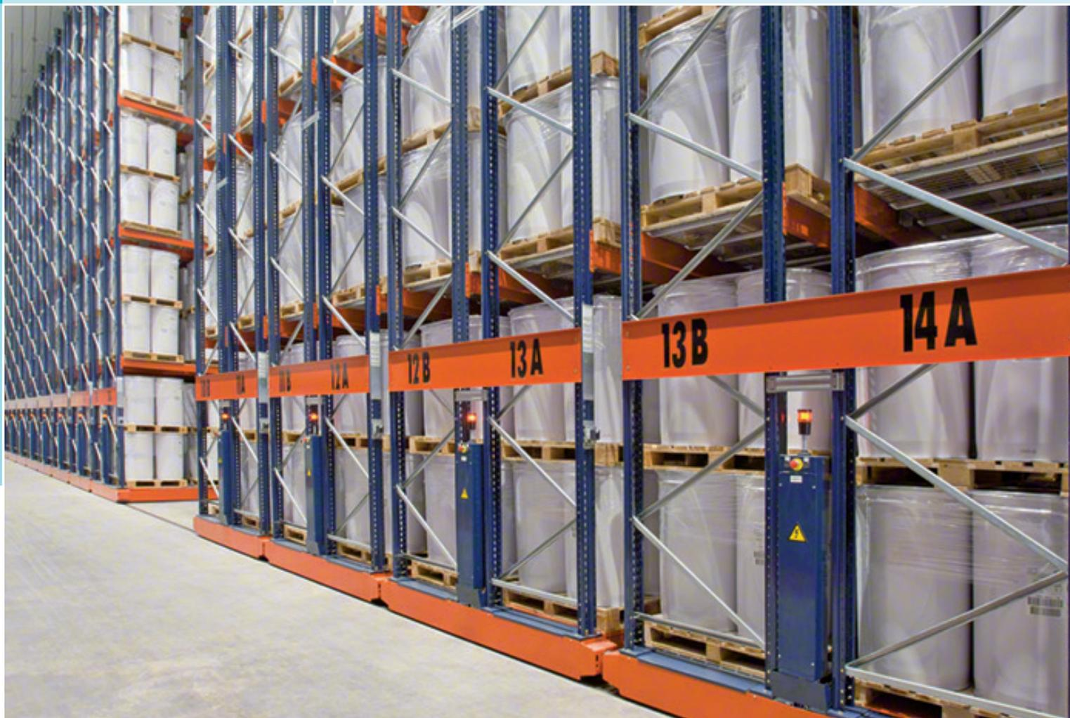
Les rayonnages sont disposés sur des bases mobiles guidées afin de supprimer les allées et d'augmenter ainsi la capacité de l'entrepôt.
