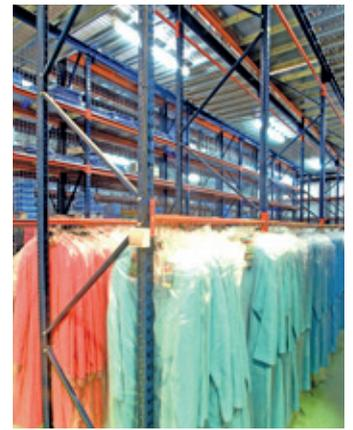
**Modules pour suspendre des produits.** Il existe deux solutions pour suspendre des vêtements ou d'autres articles; l'une se compose de lisses en forme de tringles, l'autre associe des niveaux d'étagères avec des supports et une tringle.
