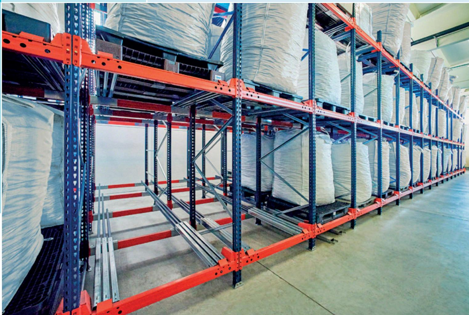
Système de stockage par accumulation permettant de stocker jusqu'à quatre palettes en profondeur sur chaque canal. Toutes les palettes d'un même canal, sauf la dernière, s'appuient sur un ensemble de chariots qui se déplacent par poussée sur les chemins de roulement. Les palettes déposées sont gérées par le principe LIFO (la dernière à entrer est la première à sortir).
