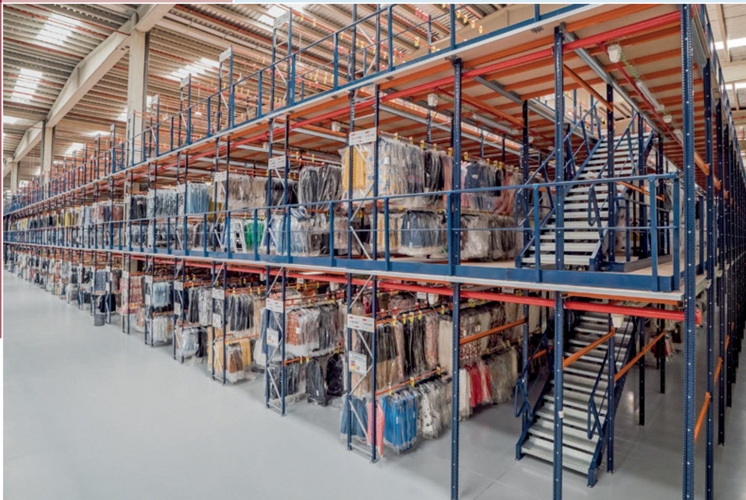
Les rayonnages avec passerelles optimisent au maximum la hauteur du magasin en permettant d'accéder aux niveaux supérieurs par des moyens mécaniques ou des passerelles posées entre les rayonnages.
