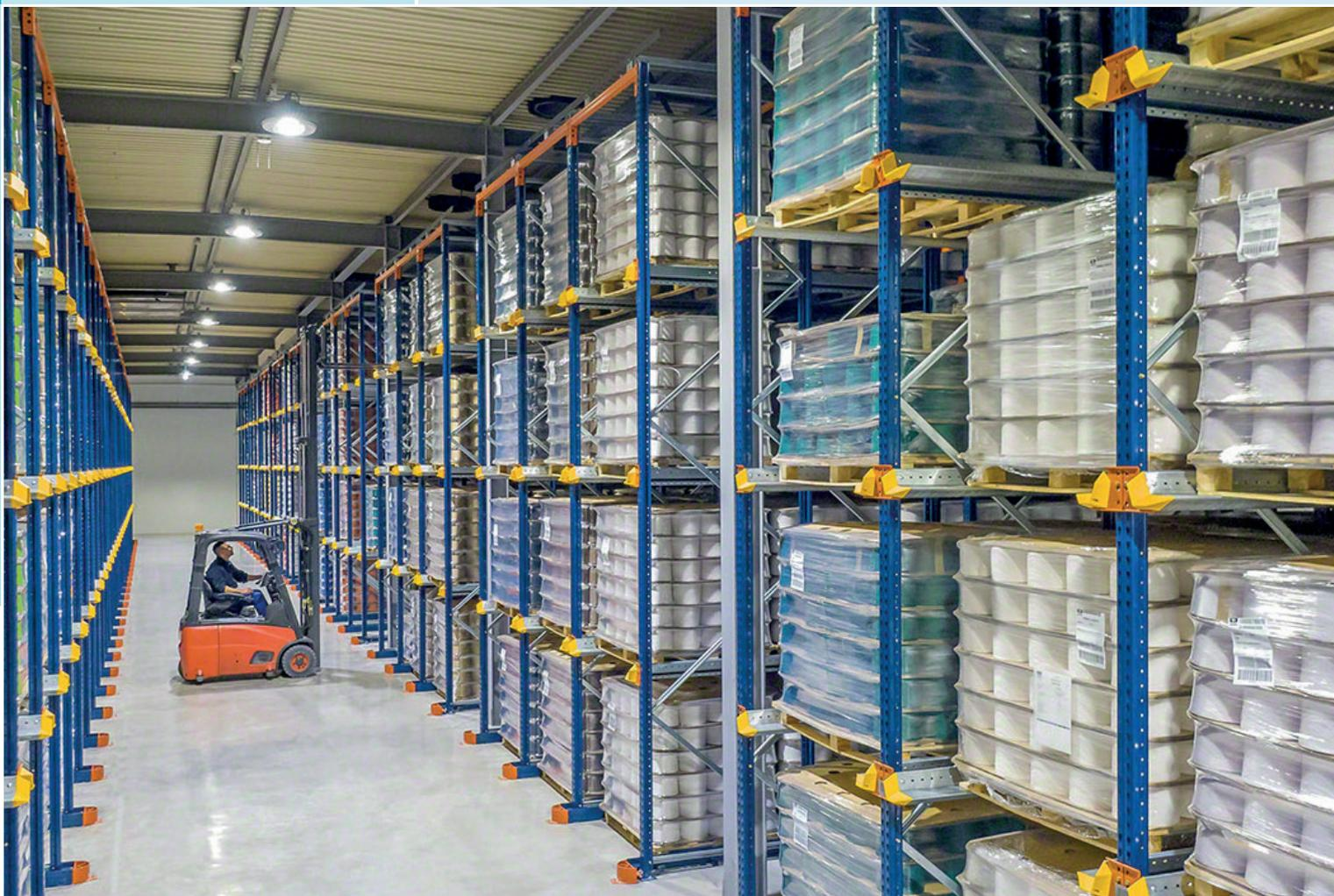
Ce système de stockage est formé d'un ensemble de rayonnages, qui constitue des couloirs intérieurs de charge munis de rails de soutien pour les palettes. Les chariots élévateurs pénètrent dans les allées intérieures avec la charge élevée au dessus du niveau de déchargement.
