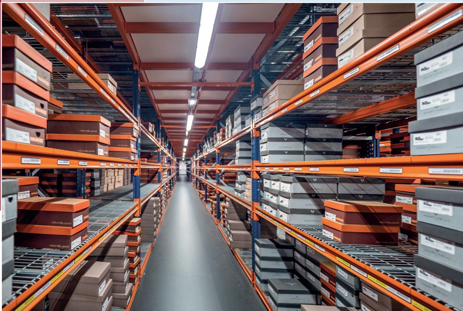
Les rayonnages pour charges mi-lourdes et volumineuses sont conçus pour les entrepôts sur lesquels les marchandises sont déposées et retirées manuellement. Ce système profite de toute la hauteur de l'entrepôt, car l'accès aux niveaux supérieurs peut être réalisé par des moyens mécaniques, qui élèvent l'opérateur jusqu'à la hauteur désirée (transstockeurs ou chariots préparateurs de commande) ou par des passerelles (planchers intermédiaires) situées entre les rayonnages.
