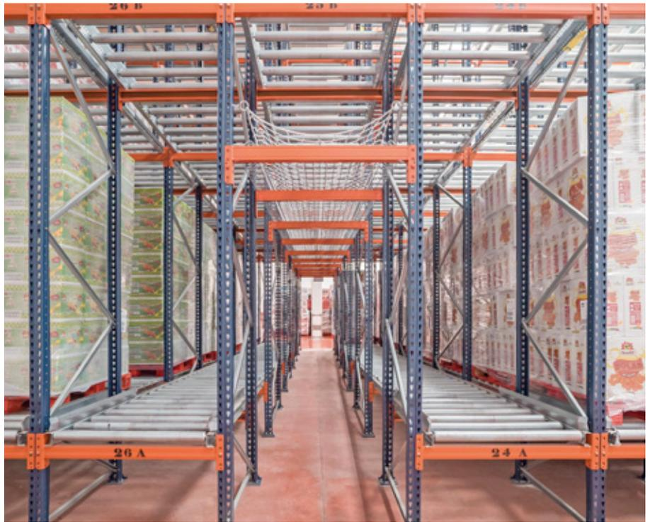
Les canaux des rayonnages, légèrement inclinés, sont équipés de rouleaux et de régulateurs de vitesse, pour contrôler le déplacement des palettes
