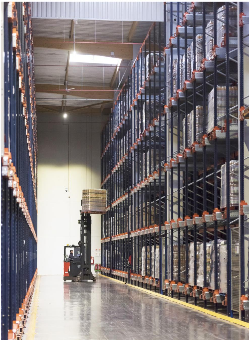
L'exploitation de l'espace du système Pallet Shuttle a permis au Groupe Alainé de minimiser les surfaces foncières, pour obtenir une capacité de stockage de 20 397 palettes
