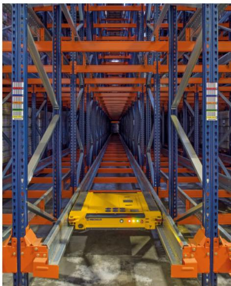
provenance de différents endroits d'Europe (principalement, la France, l'Allemagne et l'Espagne). Pour faire fonctionner le Pallet Shuttle, les opérateurs disposent d'une tablette de commande avec connexion wi-fi. Elle est équipée d'un écran très intuitif, utilisable sans formation spécifique des opérateurs, possédant de nombreuses applications et fonctions, comme sélectionner la quantité de palettes à déposer ou retirer ou dresser l'inventaire.
