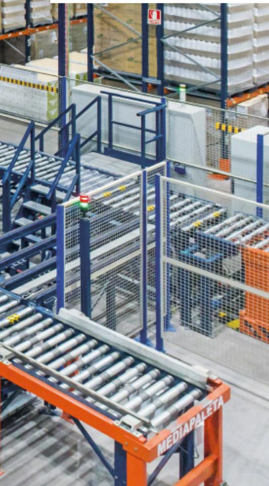
Un transstockeur monocolonne de hautes performances, doté d'un convoyeur à rouleaux, pose les palettes dans les canaux dynamiques avec une inclinaison de 4 %, ce qui facilite le déplacement par gravité des palettes de la partie la plus élevée à la plus basse.
