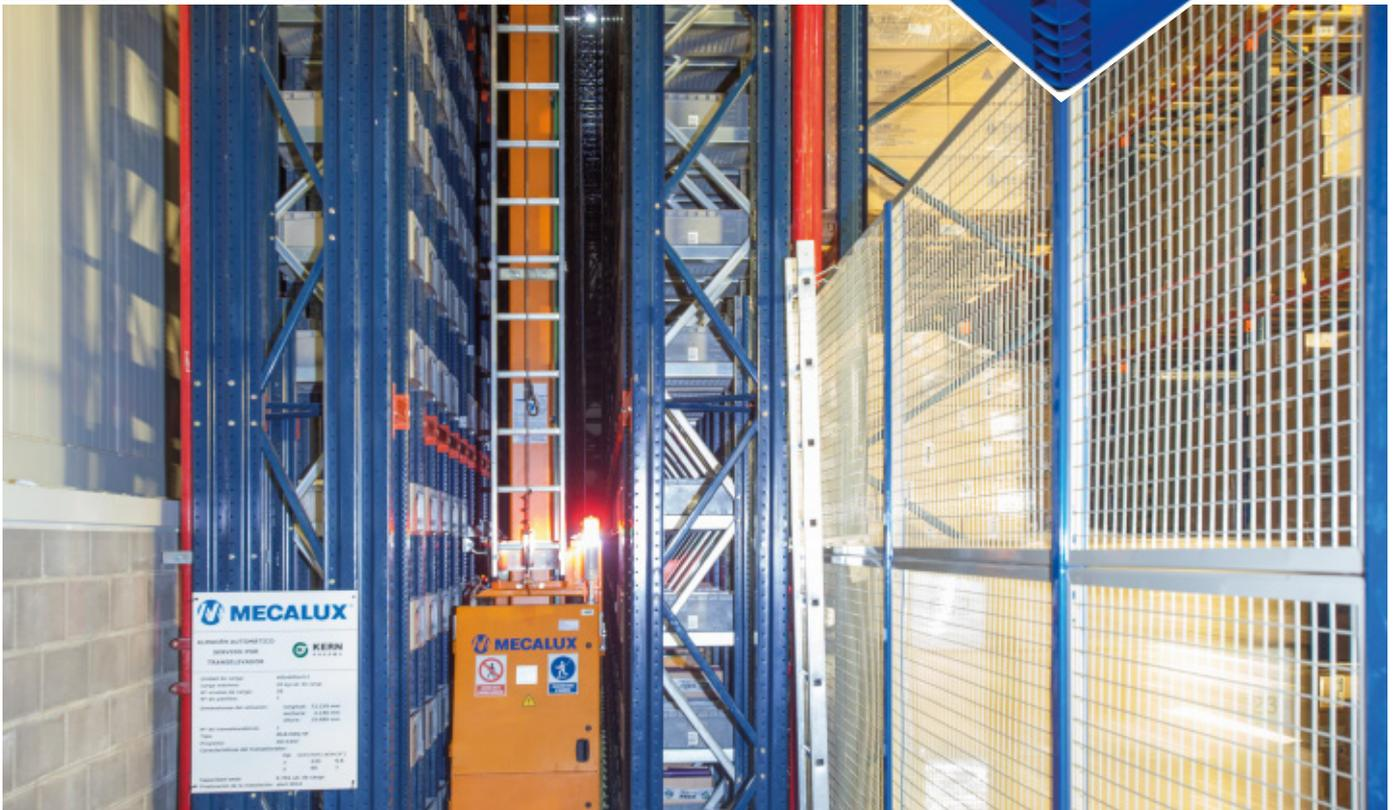
L'entrepôt a une capacité de plus de 9 700 Eurocaisses de 400 x 600 x 412 mm de 30 kg maximum
