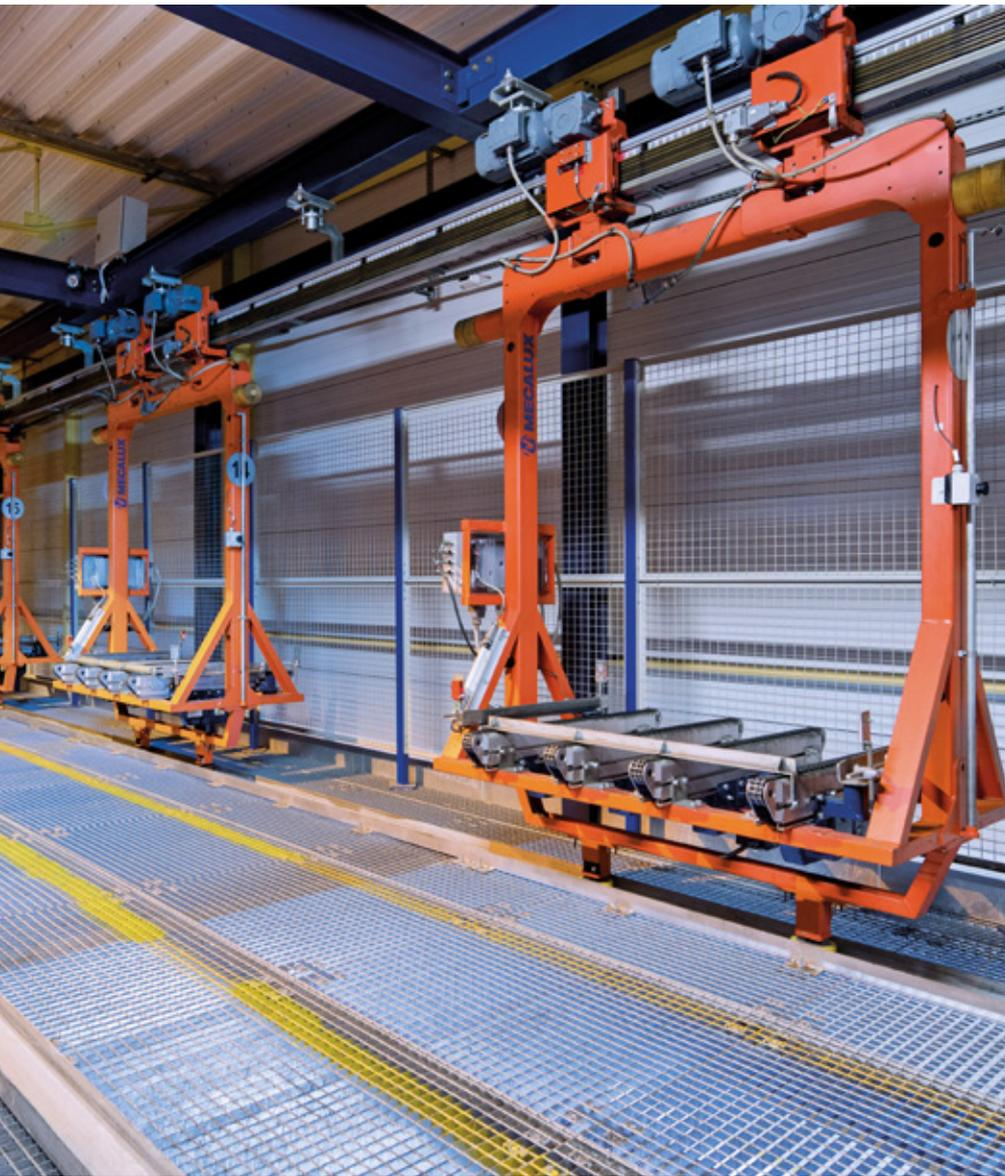
Le circuit monorail électrique requiert une intervention minimale des opérateurs et élimine la possibilité d'erreurs dérivées de la gestion manuelle
