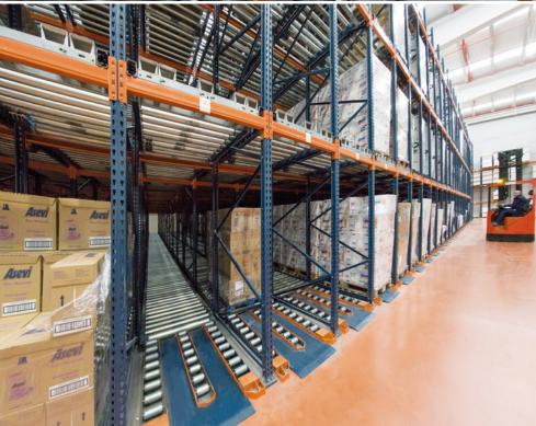
sition des rayonnages et la navette motorisée les déplace directement jusqu'au prochain emplacement libre. Pour retirer la marchandise, la même opération est réalisée en sens inverse et par l'allée de déchargement.
