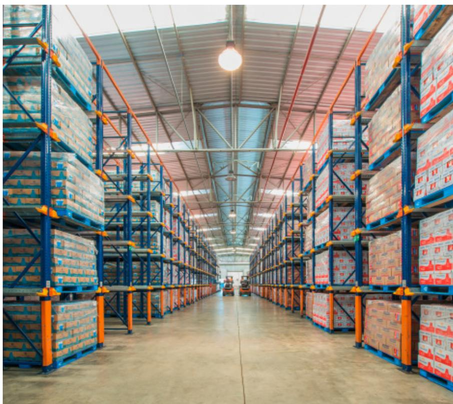
Les opérateurs pénètrent à l'intérieur des allées avec les chariots à mât rétractable en situant la charge au-dessus du niveau où elle doit être déposée. Le chargement et le déchargement de la marchandise s'effectuent dans l'allée même, mais en sens inverse.
