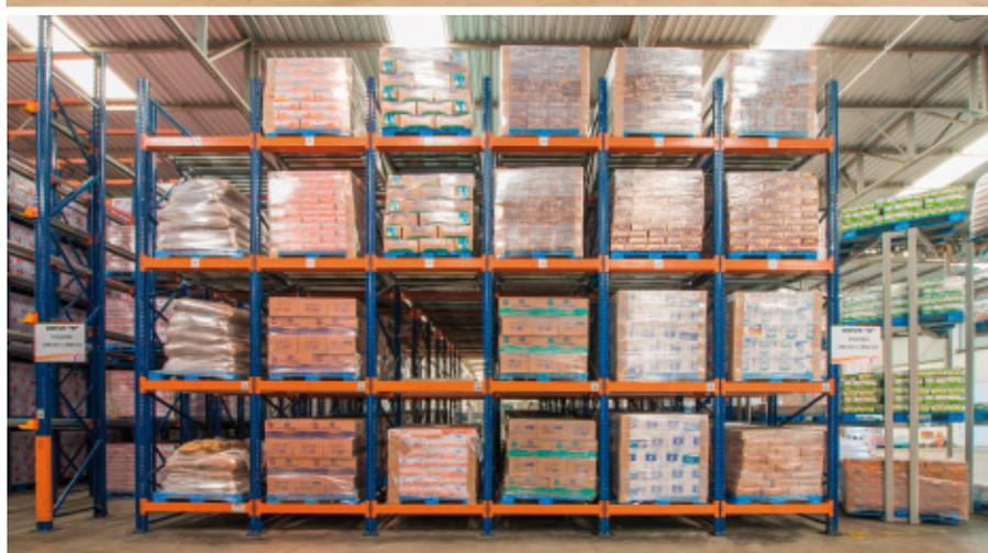
L'entreprise Lactínios Bela Vista a commandé à Mecalux trois systèmes de stockage différents pour son centre de distribution situé à Minas Gerais (Brésil) : des rayonnages à palettes par accumulation *drive-in*, des rayonnages à palettes statiques et des dynamiques.
